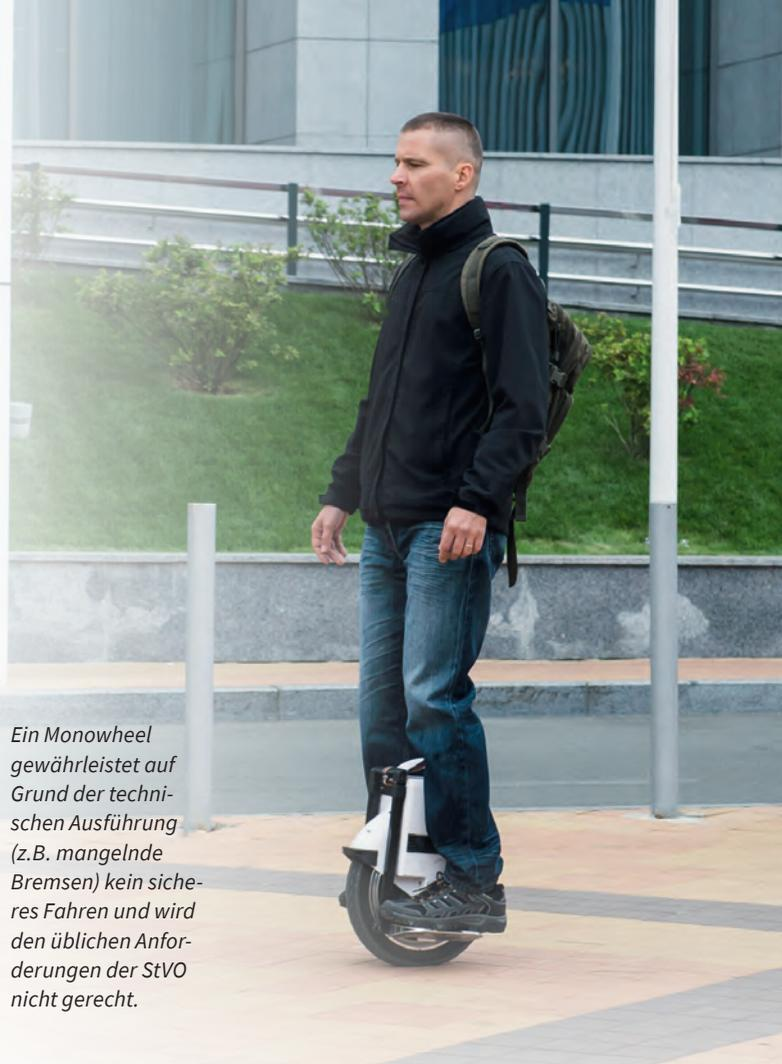
*Ein Monowheel gewährleistet auf Grund der technischen Ausführung (z.B. mangelnde Bremsen) kein sicheres Fahren und wird den üblichen Anforderungen der StVO nicht gerecht.*
