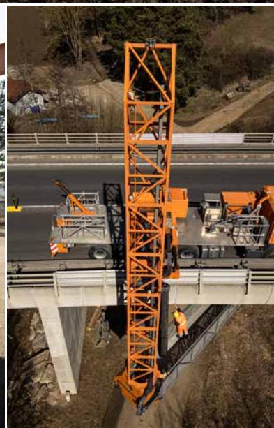
Das Brückeninspektionsgerät, das es nur einmal in Niederösterreich gibt, kommt hier für die Brückenmeisterei Krems in Rastbach bei einer Brückenprüfung zum Einsatz.
